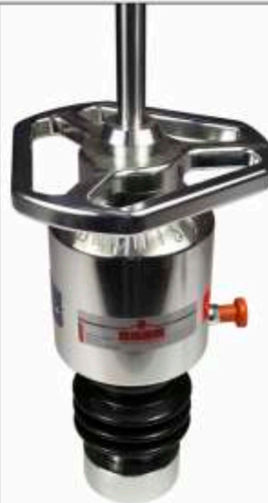
15 kg Belastungsvorrichtung 1,5 fache Stoßbelastung (Evd 70-105 MN/m 2 )
